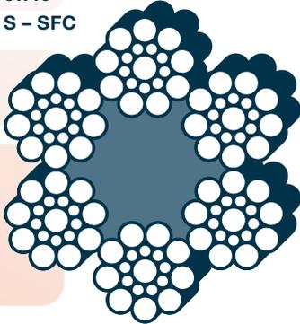
Reglerseile sind Spezialseile für Geschwindigkeitsbegrenzung, die in Sicherheitssystemen von Aufzügen verwendet werden.
